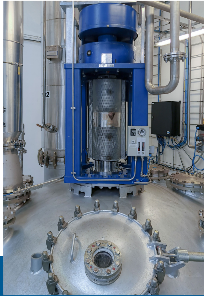
Einer der Rührbehälter
