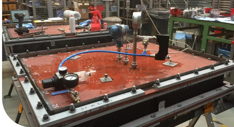
Der synthetische Kautschuk EPDM 400G musste einer Strahlenbelastung von 65 rad einer halben Stunde lang standhalten – und übertraf diese Anforderungen deutlich.
