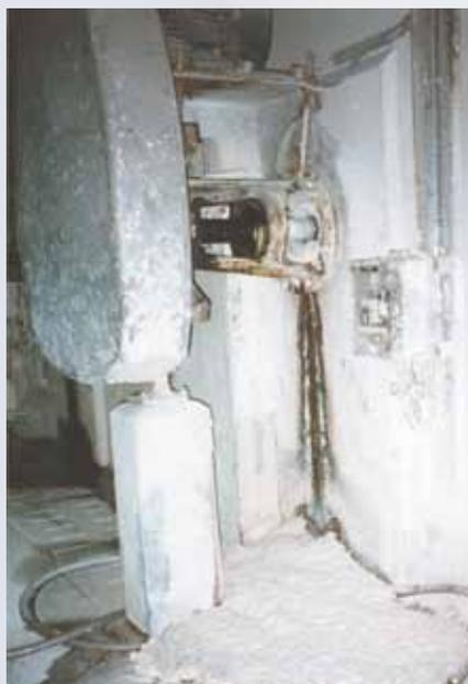
Verschmutzung und Produktverlust: Angefallene Leckage an einem mit Packungen abgedichteten Seiten-Bütenpropeller.
