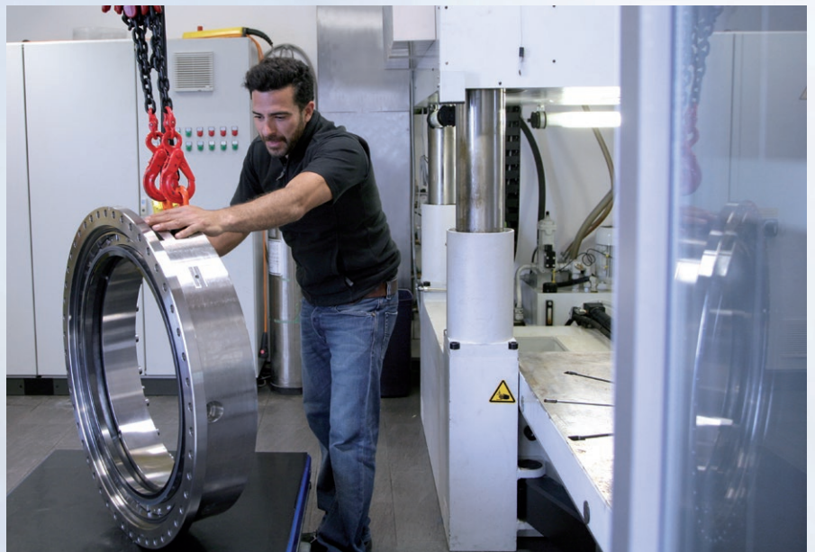
Die vollgeteilte Gleitringdichtung VGH300 für einen Wellendurchmesser von 550 mm (21,65") wird für den Testlauf vorbereitet.
