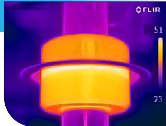
Die SeccoMix R, aufgenommen mit einer Wärmebildkamera. Die Temperaturwerte lagen deutlich unter den zugelassenen Werten der Temperaturklasse T4.
