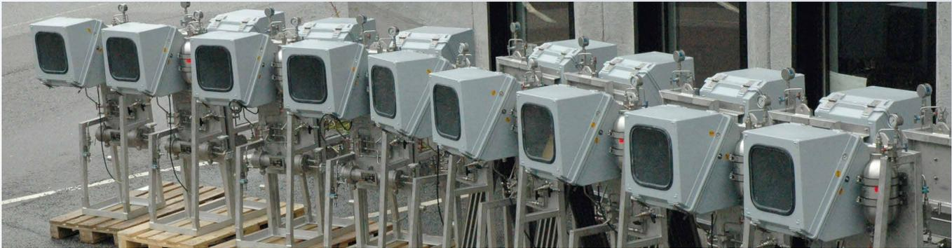
Fertig zur Auslieferung: Norsok-konforme Versorgungseinheiten von EagleBurgmann Norway für die Goliat-Plattform.
