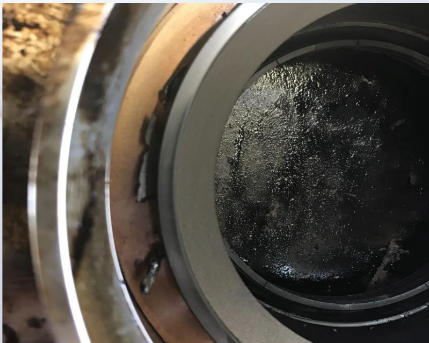
Trotz Phasen ohne Spülung waren die DiamondFace-Gleitflächen auch nach 18 Monaten im Top-Zustand.
