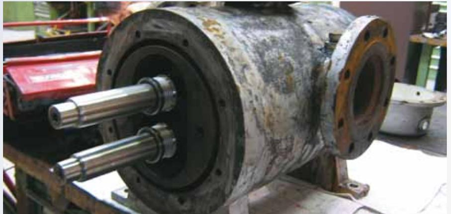
Afton Chemicals in Feluy, Belgien, stellt in seiner Produktionsanlage Additive für Schmieröle her. In dieser Anlage sind 12 Schraubenspindelpumpen von Allweiler im Einsatz mit jeweils 4 Dichtungen pro Pumpe. Die Anforderung vom Betreiber war der Einsatz einer Einzelgleitringdichtung.
